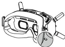
4. 确保天空端与飞行眼镜距离在 2 m 以内，当天空端对频状态指示灯绿灯常亮后则对频成功，飞行眼镜提示音停止并且可显示图传画面。
